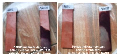
Gambar 4. Kertas indikator setelah ditetesi larutan HCL dan NaOH
