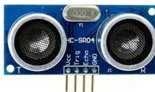
Gambar 3. Sensor Ultrasonik HC-SR04 (sumber : teknisibali.com)
