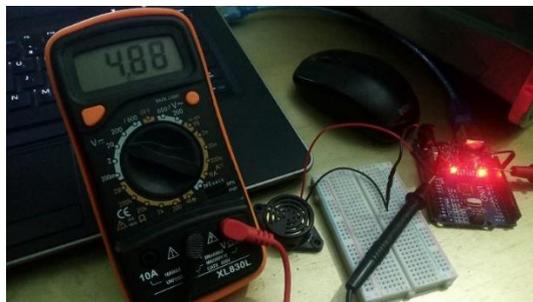
Gambar 7. Pengukuran tegangan pada *buzzer*
