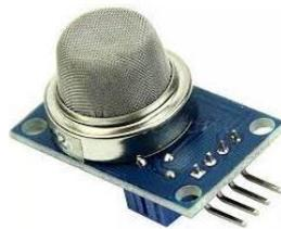
Gambar 2. Sensor Gas MQ 2 (sumber : jagotomasi.com)
