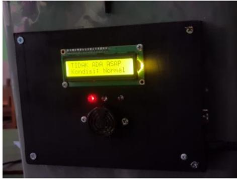
Gambar 10. Peringatan melalui LCD, lampu LED dan buzzer
