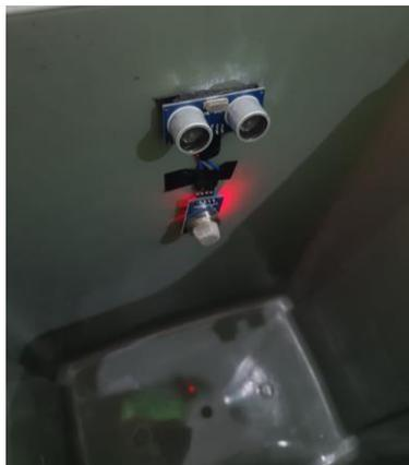
Gambar 10. Posisi sensor ultrasonik dan gas
