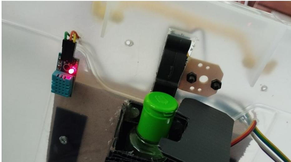
Gambar 6. Sensor DH11 dan Motor Servo
